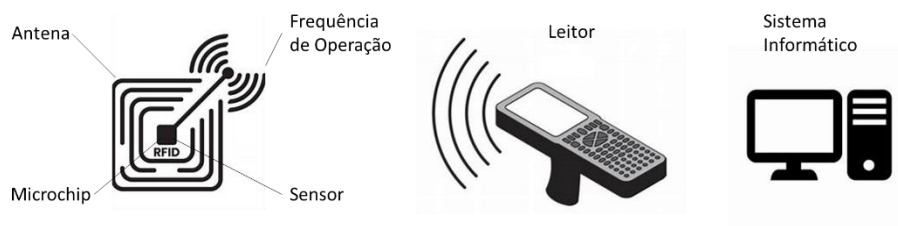
Figura 20 – Desenho esquemático da arquitetura de um Sistema RFID.
