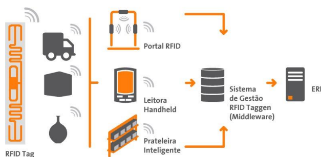
Figura 19 – Sistema funcionamento de um RFID Fonte: (Medium, 2021).
