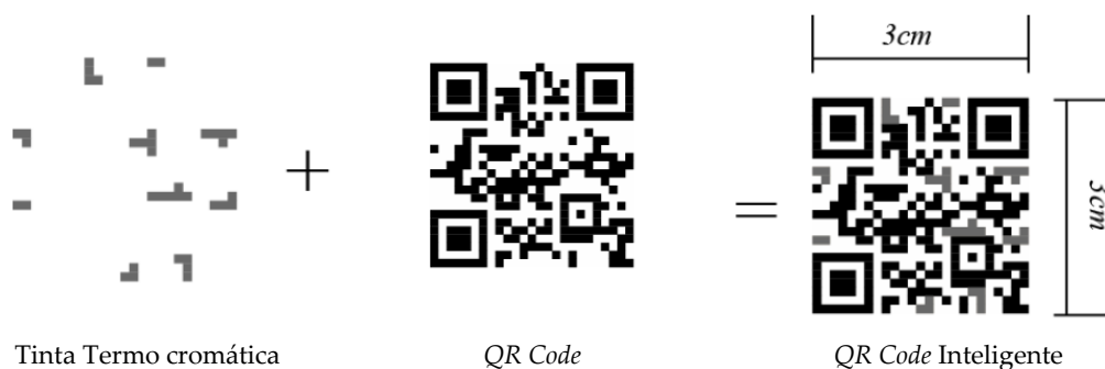
Figura 16 - QR Code Inteligente. Utiliza tinta Termo cromática e QR Code para identificação da temperatura adequada do produto. Fonte: (Djurdjovic et al., 2019)
