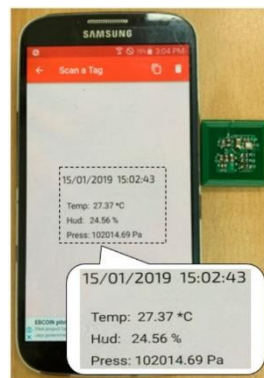
Figura 24 – Sistema Chipless RFID sensor (NFC) para monitorização de temperatura e pressão. Fonte: (Nguyen et al., 2019)
