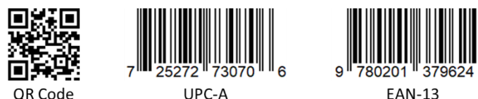
Figura 14 – Diferentes tipos de Bar Codes, comumente utilizadas no mercado. A esquerda, QR Code (2-D), ao centro UPC-A (1-D) e a direita EAN-13 (1-D). Fonte: (FreeBarcode, 2021)
