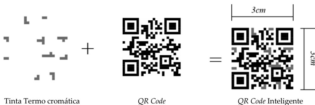
Figura 15 - QR Code Inteligente. Utiliza tinta Termo cromática e QR Code para identificação da temperatura adequada do produto. Fonte: (Djurdjovic et al., 2019)
