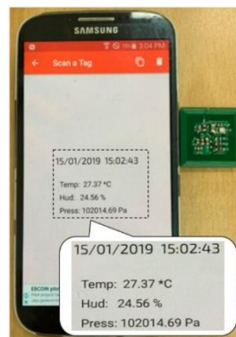
Figura 23 – Sistema Chipless RFID sensor (NFC) para monitorização de temperatura e pressão. Fonte: (Nguyen et al., 2019)
